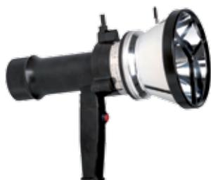
Maletín de pruebas que incluye un simulador de llama ATEX/IECEx para uso en Zona 1 y Zona 21. Alineamiento fácil con puntero láser y distancia de prueba de 12 m (según sensibilidad y tipo de detector). Incluye carcasa antideflagrante con batería para 1.000 test, cargador y maleta para comprobar los detectores de llama SPECTREX IR3 y Multi-IR.
