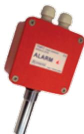
Sonda térmica autorrearmable con rango de activación entre 99°C y 115°C (clase D) montada en caja de aluminio estanca con grado de protección IP 66. Apto para interiores y exteriores. Compatible con la mayoría de las centrales convencionales del mercado y con centrales analógicas de HLSI mediante un módulo de zona.
